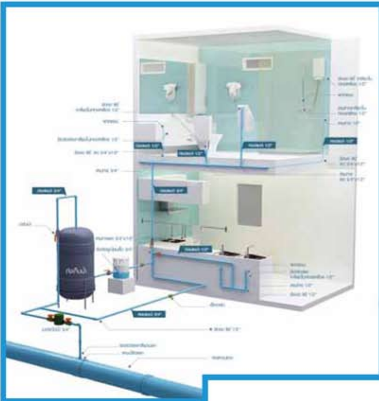
ระบบประปา Water supply System
